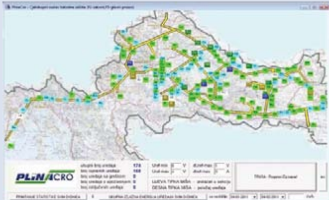
LOKACIJE UREĐAJA KATODNE ZAŠTITE UZDUŽ PLINOVODA PLINACRO KOJI KOMUNICIRAJU S CENTROM U ZAGREBU
