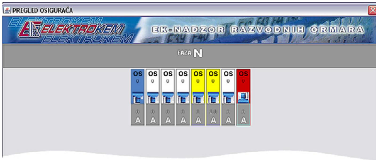
Klikom lijeve tipke miša na određeni razvodni ormar u glavnom sučelju programa korisnik pregledava alarne koji su se dogodili za pojedine osigurače unutar ormara. Nakon pregleda svih alarma za pojedine osigurače u odabranom razvodnom ormaru povratak u glavno sučelje programa moguć je te nakon zatvaranja trenutnog sučelja za rad sa osiguračima.
