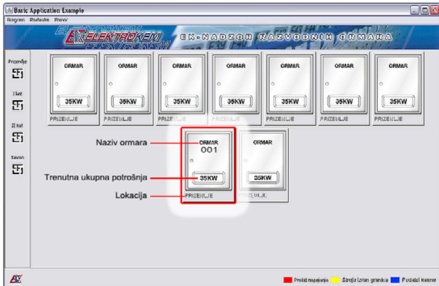
Lokacija razvodnog ormara omogućava lako pronađenje pojedinog razvodnog ormara na tlocrtu instalacije.
