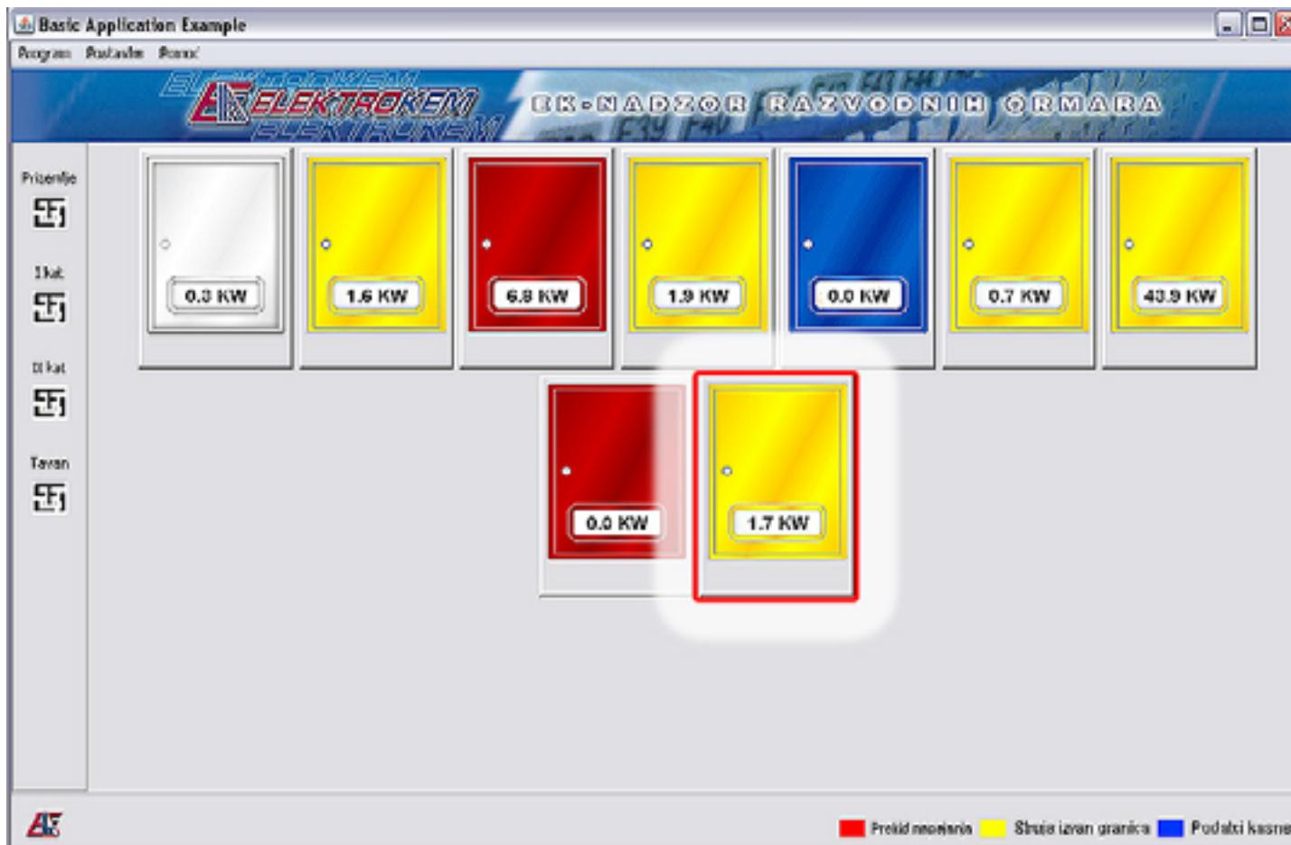
Signalizira prekoračenje dozvoljene struje na jednom ili više osigurača unutar pojedinog razvodnog ormara. Ograničenje protoka električne struje za pojedini osigurač može se podešiti putem administracijskog sučelja, te je u početnim tvorničkim postavkama podešena na vrijednost osigurača, to jest maksimalna.
