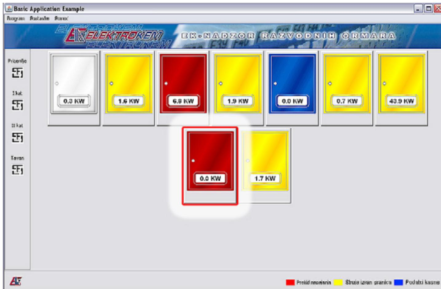
Signalizira prekid jednog ili više osigurača unutar pojedinog razvodnog ormara. Alarm prekida osigurača ima viši prioritet od alarma graničenja struje, te će on biti aktiviran ukoliko se oba alarma dogode istovremeno. Oznaka boje: crveno.
